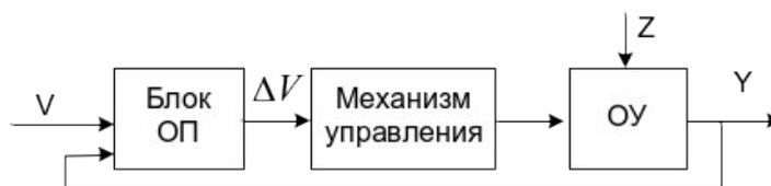
Рисунок 10.3 –Схема контура управления
